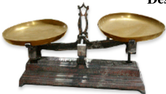
Une balance Roberval et ses masses marquées
